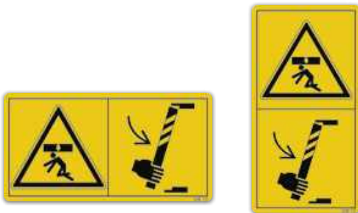
Der Aufenthalt im Gefahrenbereich ist nur bei eingelegerter Sicherheitsstütze zulässig.
