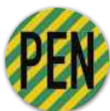
Neutralleiter mit Schutzfunktion (PEN-Leiter)
